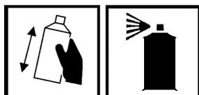
Bien mélanger le primaire en agitant le récipient pendant 2 à 3 minutes à partir du moment où l'on sent que les billes de mélange bougent. Effectuer un essai de pulvérisation. Appliquer l'apprêt uniformément sur la surface à recouvrir à une distance de 20 à 25 cm.
