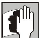
Enlever soigneusement toutes les taches de corrosion et poncer à sec avec du papier abrasif P320-P400.
